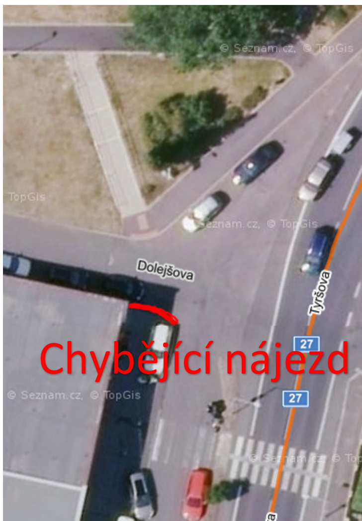
Obrázek 1 – chybějící bezbariérový přístup na chodník
