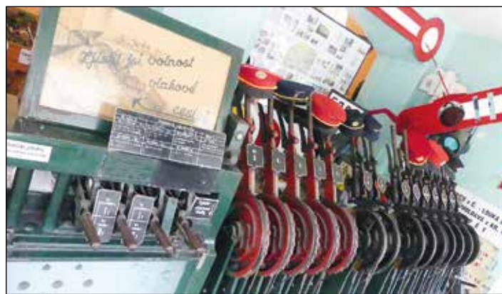
Nejcennější exponát - původní mechanický přístroj na ovládání výhybek a návěstidel z roku 1940 vyrobený v německém Düsseldorfu
