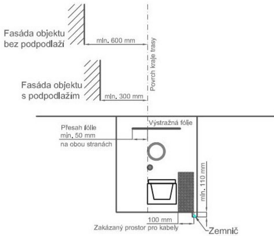
Obrázek 6 Společná pravidla pro uložení kabelů
